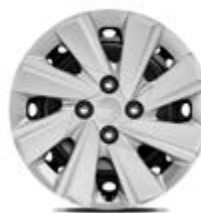
15 palcové ocelové disky kolies s okrasnými plastovými krytmi (pneumatiky 185/65 R15)
